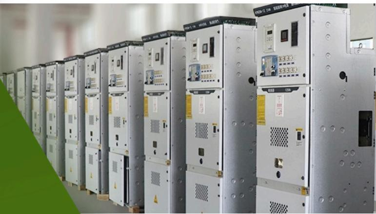
Las Subestaciones NV-MT-V Series para 13.8, 23 y 34.5 kV, servicio interior o servicio intemperie, están construidas con lámina de acero rolado en frío terminadas con pintura de acabado a base de polvo secada en horno, previo tratamiento desoxidado, desengrasado y fosfatizado por aspersión en caliente a 180°C.
